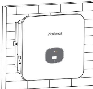
6. Depois de assegurar que o inversor está encaixado no suporte, aperte firmemente o parafuso que fixa o inversor no suporte.
