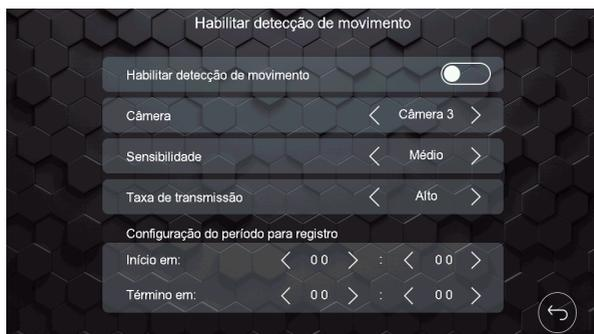
*Pantalla de configuración de detección de movimiento*
