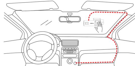
Retire a proteção da fita dupla face e cole a câmera no adesivo eletrostático.
