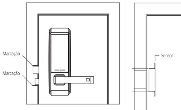
16. Posicione o sensor sobre a face do batente para efetuar as marcações dos furos (o ímã deve ficar para baixo para fazer contato com o trinco). Faça as furações necessárias para embutir o sensor no batente e as duas furações necessárias para parafusar o sensor e a contratesta;
