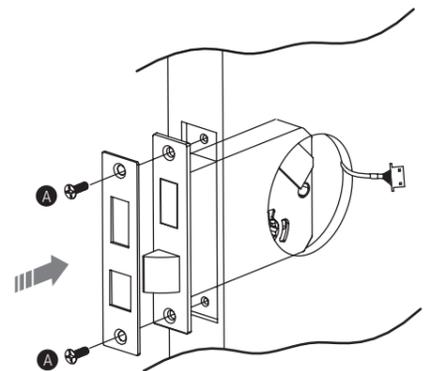
**Importante:** ao encaixar o mecanismo na porta, certifique-se que o cabo não sofrerá nenhum tipo de dano. Não faça a instalação caso note qualquer dano no cabo do mecanismo! Nesta situação, procure uma assistência técnica autorizada.
