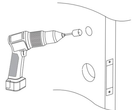
3. Passe o cabo do mecanismo pelo furo, de modo que ele saia para o lado interno do ambiente;
