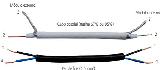
*Instalação com cabo coaxial até 100 metros*
