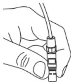
2. Desenganche la fibra del conector. Deslice el cierre hacia el lado indicado por la flecha.
