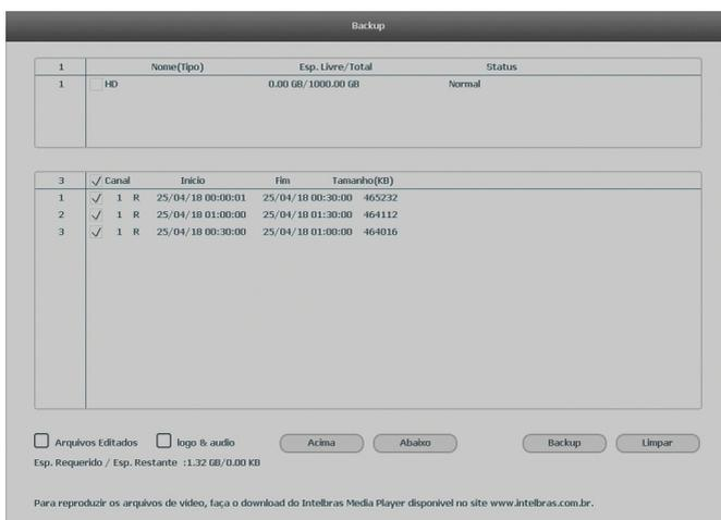
3. Escolha o dispositivo no qual deseja armazenar os arquivos: HD ou USB (necessário um dispositivo USB, formatado em FAT32, conectado ao DVR);
