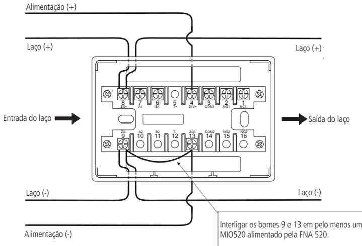
Conexão saída 24 V com módulo de entrada e saída
