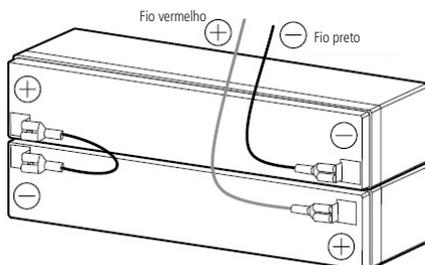
Conexão das baterias (vista superior)
