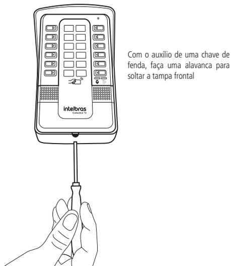
Com o auxílio de uma chave de fenda, faça uma alavanca para soltar a tampa frontal
