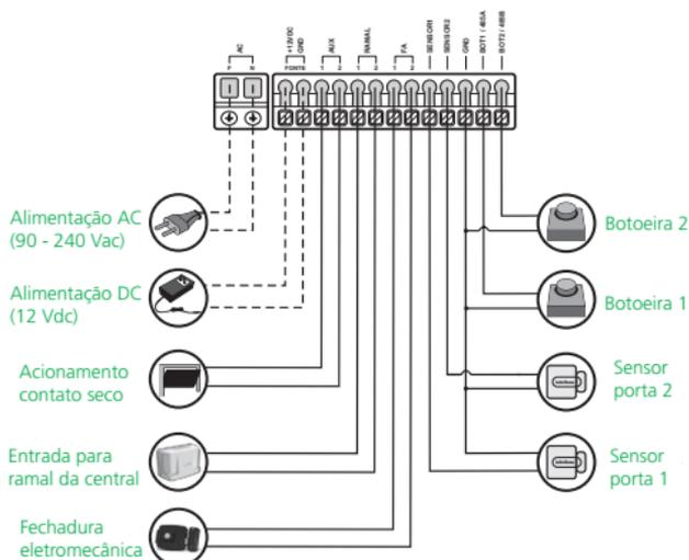
**Obs.:** verifique a configuração do jumper JP5 do terminal, dependendo do dispositivo acionado pela saída de contato seco. Em caso de motor de garagem, o JP5 fica configurado como NA (padrão de fábrica), em caso de fechadura eletromagnética, o JP5 fica configurado como NF.
