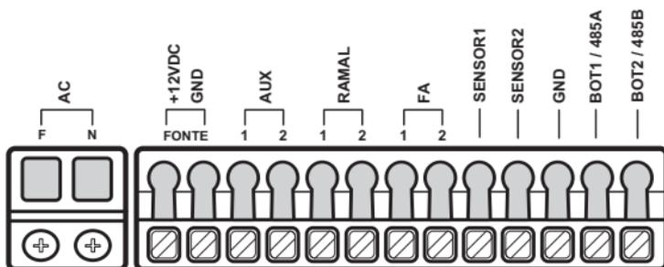
**AC:** entrada de alimentação AC de 90 à 240Vac/50 ou 60 Hz. Para instalar o produto com a rede AC não se deve ligar a fonte externa ao produto.
