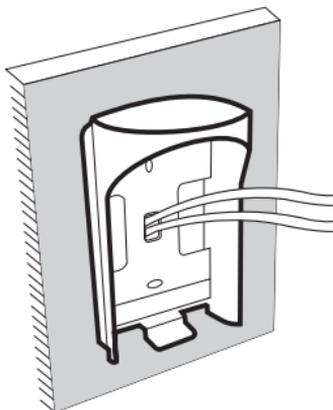
3. Parafuse a tampa traseira, juntamente com o protetor de chuva no local selecionado para a instalação do XPE 1001/1013 PLUS;
