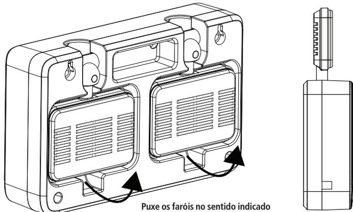
4. Posicione o produto alinhando os engates rápidos sobre os parafusos, deslizando-o para baixo até ocorrer o completo encaixe.
