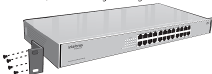
Fixação dos suportes em "L"
