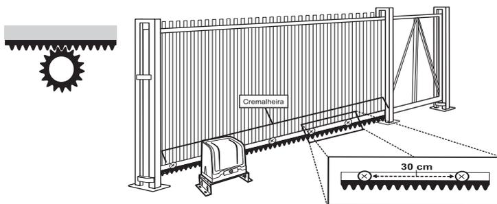
9. Desparafuse o automatizador, retire as arruelas e parafuse novamente o acionador à base. As arruelas foram retiradas criarem um espaçamento de aproximadamente 2 mm entre a cremalheira e a engrenagem, evitando assim o desgaste excessivo do equipamento.
