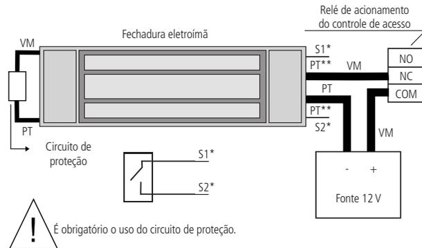
\* Alguns modelos de fechadura possuem sensor para detectar que a fechadura está magnetizada e a porta fechada.
