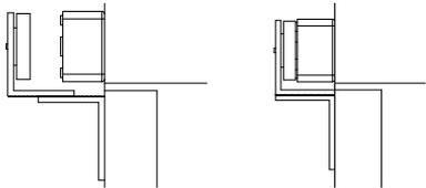
Exemplo de instalação em porta de divisória, que abre para dentro, e em batente de divisória:
