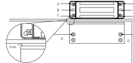
**Obs.:** na fechadura existem 3 pares de furos como opção de fixação. No suporte auxiliar recomendamos utilizar as furações "D".
