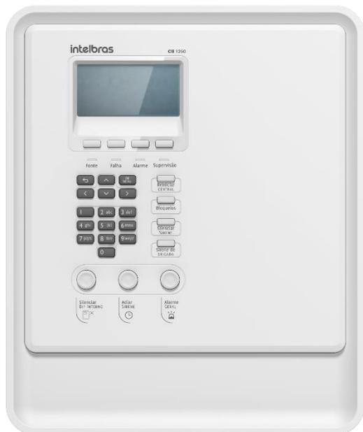
La central de alarma de incendio CIE 1250 soporta hasta 250 dispositivos en su lazo. Fabricada con diseño moderno y desarrollada con alta tecnología, posee bivolt automático, un año de garantía y posibilidad de instalación en clase A o B. Es compatible con los dispositivos direccionables de la línea 520, tales como accionadores, detectores y sirenas.
