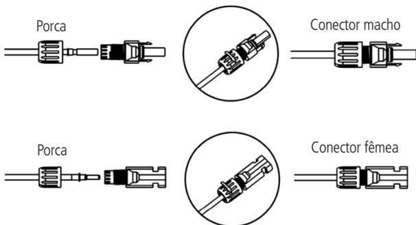
5. Após realizar a conectorização, conecte os conectores na entrada CC (MPPT) do inversor.
