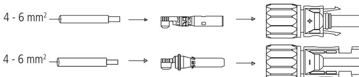
1. Para ligação do arranjo fotovoltaico ao inversor utilize cabo isolado apropriado para o uso em sistemas fotovoltaicos;
