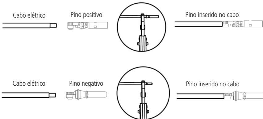
4. Transpasse a porca pelo pino crimpado no cabo e deixe-o em espera. Insira o pino do cabo no conector até o final até quando ouvir um clique e então, rosqueie a porca no conector para travar o cabo (a porca não precisa chegar ao final e posteriormente aperte apenas o suficiente para prender o cabo). Após esse procedimento os conectores estarão prontos para serem utilizados;
