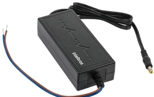
A EF 1205S é uma fonte de alimentação AC/DC de 12 V projetada sem plugue bipolar, facilitando a instalação em cenários sem ponto de tomada, ideal para uso em câmeras de sistemas CFTV, fitas de iluminação LED, sistemas de controle de acesso, entre outras aplicações. Com sua corrente máxima de 5 A, é capaz de alimentar até 20 câmeras HD\*.
