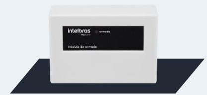
Esse dispositivo deve ser endereçado na central utilizando o resistor de 10k, não precisa ser configurado pois o MDI 520 possui apenas um modo de operação, sua função é apenas receber um acionamento por contato seco além de não precisar de alimentação 24 Vc.
