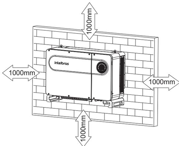
6. O método de instalação e o local de montagem devem ser adequados ao peso e às dimensões do inversor. Selecione uma parede ou superfície vertical sólida para fazer a instalação.
