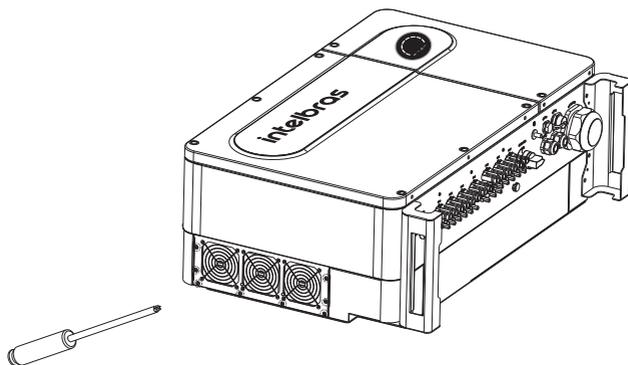
3. Desconecte o cabo das ventoinhas e remova as grades de proteção, conforme a seguir.
