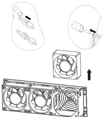
4. Limpe as ventoinhas, as grades de proteção e o dissipador de calor ou substitua a ventoinha em caso de defeito;
