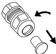
3. Passe o(s) cabo(s) através do orifício do prensa-cabo e o conecte-o(s) ao(s) plugue(s) do conector RS-485. O cabo recomendado para essa conexão é o STP.
