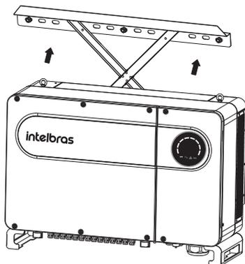
5. Certifique-se de que o inversor fotovoltaico esteja firmemente conectado ao suporte e trave todos os parafusos.
