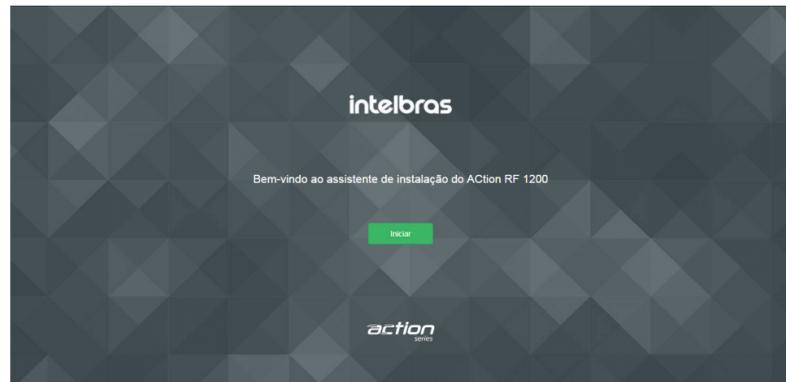
Após iniciar o assistente de instalação, sua conexão com a internet será reconhecida automaticamente. Aguarde e siga as orientações descritas no assistente de instalação. Para criar a sua rede Wi-Fi, a senha Wi-Fi e a senha de acesso à página de configuração do seu roteador, preencha os campos exibidos na tela seguinte.
