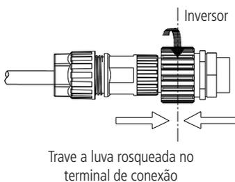
5. Para remover o terminal de conexão CA, desenrosque a luva rosqueada e puxe-a para fora, no sentido oposto ao conector do inversor.
