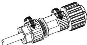
4. Por fim, empurre o terminal montado em direção ao terminal de conexão do inversor até que ambos estejam firmemente travados.
