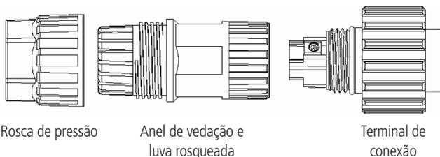
2. Insira o cabo com o cobre exposto através da rosca de pressão, anel de vedação, luva rosqueada e em sequência, insira os cabos no terminal de conexão de acordo com as polaridades indicadas nele e aperte firmemente os parafusos. Tente puxar o cabo para garantir que ele esteja bem conectado.
