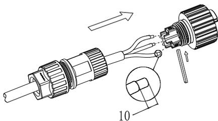
3. Empurre a luva rosqueada no terminal de conexão e aperte-a no terminal.
