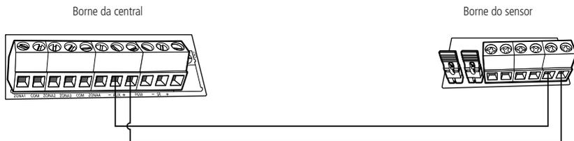
Esta saída é utilizada para alimentar acessórios, como por exemplo, sensores de infravermelho. Recomenda-se a utilização de um cabo com bitola  $\leq 26$  AWG (0,41 mm).
