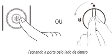
Com a função *Travamento automático* ativada, o travamento ocorrerá automaticamente em até 2 segundos após o fechamento da porta.
