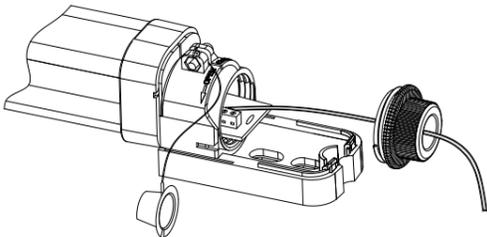
6. Ligue a alimentação obedecendo a polaridade indicada na placa do receptor e do transmissor. Após isso, ligue os fios do alarme na entrada de zona da central de alarme;
