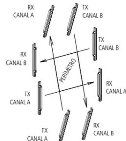
» A fim de evitar interferências entre sensores no mesmo canal, respeite a distância de proteção lateral conforme especificado abaixo.
