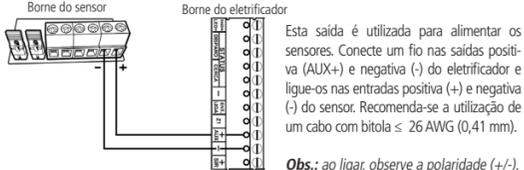
Esta saída é utilizada para alimentar os sensores. Conecte um fio nas saídas positiva (AUX+) e negativa (-) do eletrificador e ligue-os nas entradas positiva (+) e negativa (-) do sensor. Recomenda-se a utilização de um cabo com bitola ≤ 26 AWG (0,41 mm).
