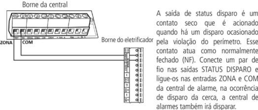
A saída de status disparo é um contato seco que é acionado quando há um disparo ocasionado pela violação do perímetro. Esse contato atua como normalmente fechado (NF). Conecte um par de fio nas saídas STATUS DISPARO e ligue-os nas entradas ZONA e COM da central de alarme, na ocorrência de disparo da cerca, a central de alarmes também irá disparar.
