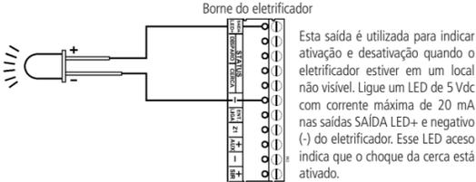
Esta saída é utilizada para indicar ativação e desativação quando o eletrificador estiver em um local não visível. Ligue um LED de 5Vdc com corrente máxima de 20 mA nas saídas SAÍDA LED+ e negativo (-) do eletrificador. Esse LED aceso indica que o choque da cerca está ativado.
