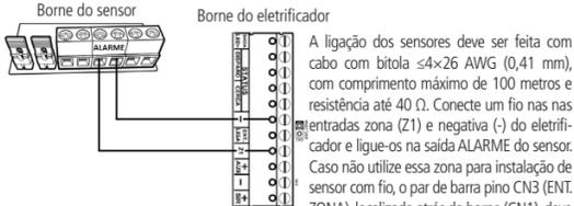
A ligação dos sensores deve ser feita com cabo com bitola ≤4x26 AWG (0,41 mm), com comprimento máximo de 100 metros e resistência até 40 Ω. Conecte um fio nas nas entradas zona (Z1) e negativa (-) do eletrificador e ligue-os na saída ALARME do sensor. Caso não utilize essa zona para instalação de sensor com fio, o par de barra pino CN3 (ENT. ZONA), localizado atrás do borne (CN1), deve ficar fechado com o jumper.
