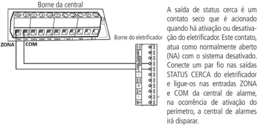
A saída de status cerca é um contato seco que é acionado quando há ativação ou desativação do eletrificador. Este contato, atua como normalmente aberto (NA) com o sistema desativado. Conecte um par fio nas saídas STATUS CERCA do eletrificador e ligue-os nas entradas ZONA e COM da central de alarme, na ocorrência de ativação do perímetro, a central de alarmes irá disparar.
