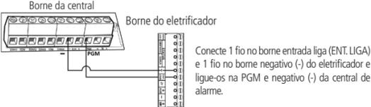
Conecte 1 fio no borne entrada liga (ENT. LIGA) e 1 fio no borne negativo (-) do eletrificador e ligue-os na PGM e negativo (-) da central de alarme.
