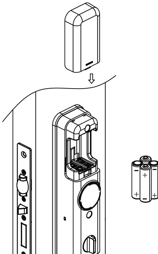
2. **Insira o módulo ZigBee:** abra o compartimento do botão de cadastro e insira o módulo ZigBee no local indicado, tomando cuidado para não danificar o conector.
