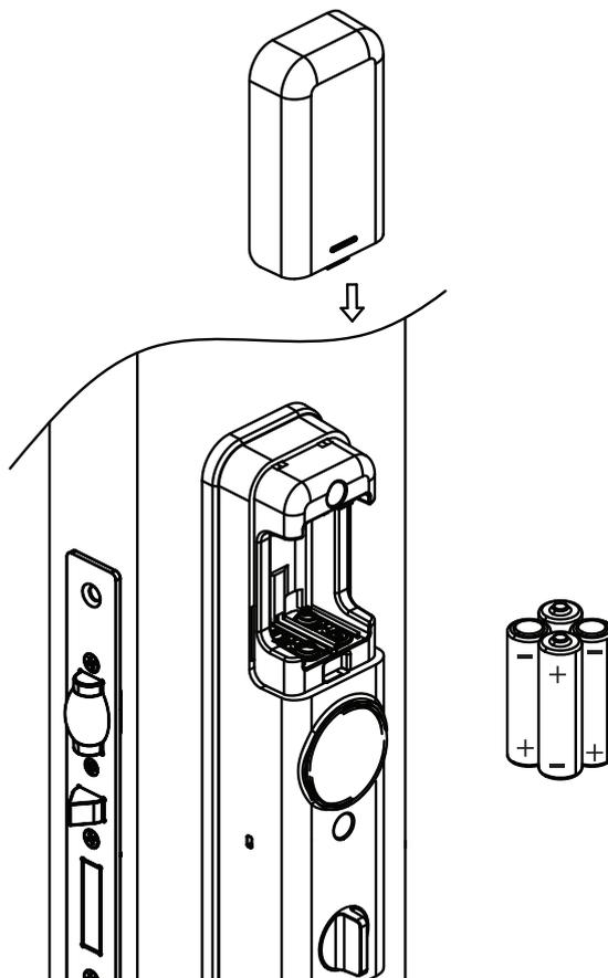
2. **Retire o módulo ZigBee:** abra o compartimento do botão de cadastro, aonde encontra-se o módulo ZigBee, e retire a placa com cuidado para não danificar o conector.
