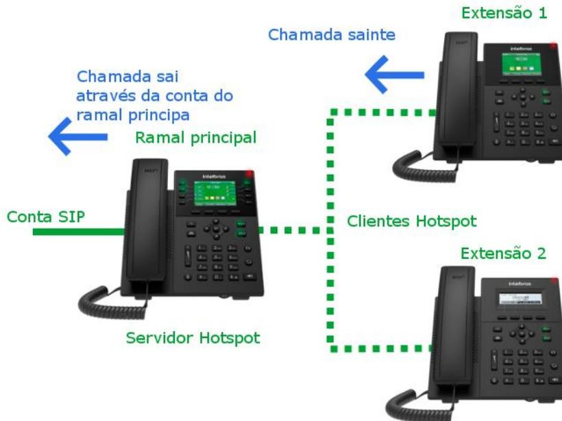
Figura 2 – Chamada originada através de uma das extensões (Clientes Hotspot)
