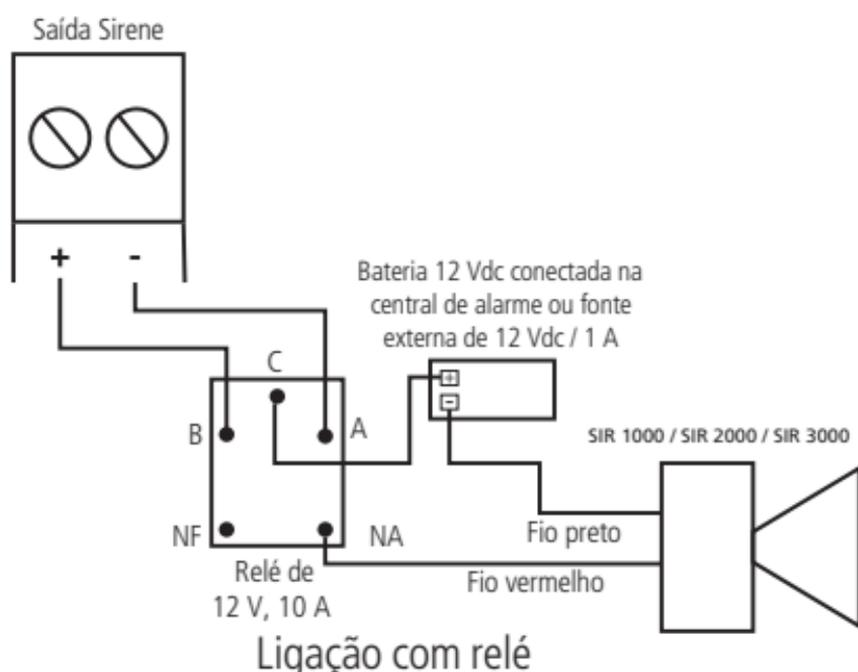
**Atenção:** as centrais de alarme Intelbras precisam estar com bateria para o funcionamento das sirenes modelos SIR 2000 e SIR 3000. Assim como alguns modelos de centrais Intelbras, independente do modelo da sirene não tocam a sirene sem bateria.
