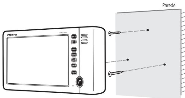
2. Após a fixação dos parafusos, deslize o módulo interno para baixo até encaixar.
