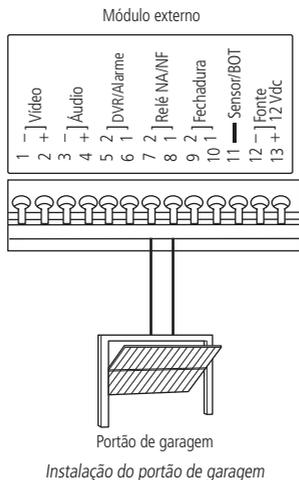
**Obs.:** os dois pares de fios que são conectados nos contatos 7 e 8 do módulo externo devem ser ligados nos contatos de botoeira da interface do portão de garagem.
