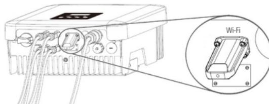
**Obs.:** » O inversor precisa estar totalmente desligado antes de conectar o pocket Wi-Fi! Após desligar todas as chaves aguarde 5 minutos.
