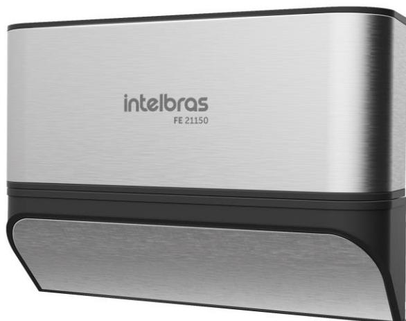
El modelo FE 21150 D está diseñado para puertas que se abren hacia adentro y utiliza como principio de funcionamiento una fuerza magnética de 150 kgf. Con estructura y soportes de acero, y una tapa de protección de ABS reforzada con revestimiento de acero inoxidable, el producto es leve, de alta resistencia a la corrosión y bajo magnetismo residual.
