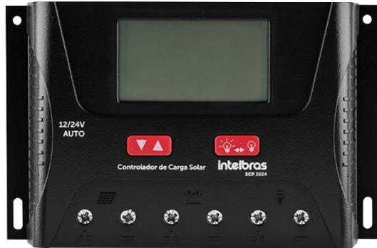
O controlador de carga é o dispositivo utilizado para gerenciar e controlar o processo de carga e descarga do banco de baterias. Instalado entre o módulo fotovoltaico e a bateria, protege, otimiza e prolonga a vida útil da mesma. Possui saída para alimentação direta de cargas CC e saída USB 5 Vcc.
