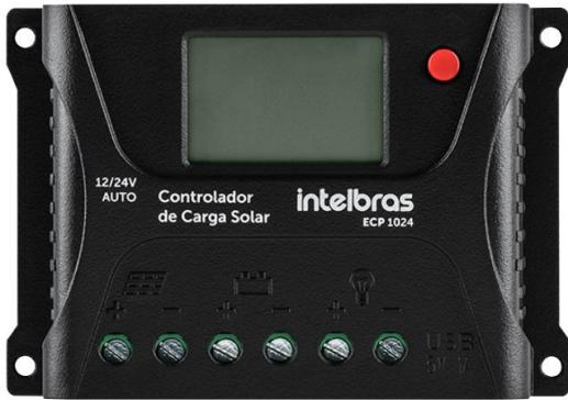
O controlador de carga é o dispositivo utilizado para gerenciar e controlar o processo de carga e descarga do banco de baterias. Instalado entre o módulo fotovoltaico e a bateria, protege, optimiza e prolonga a vida útil da mesma. Possui saída para alimentação direta de cargas CC e saída USB 5 Vcc.
