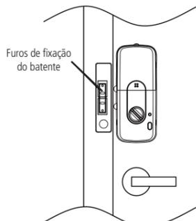
15. Faça as furações e parafuse o batente ou falsa-testa no local marcado. Para fixar, utilize quatro parafusos B (M4 x 25);
