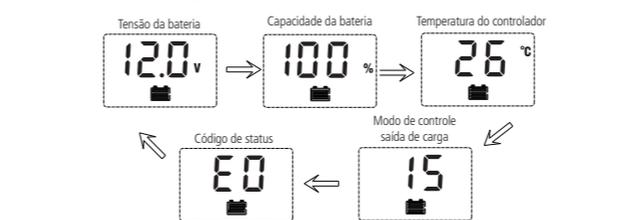
**Controlador ECP 2024:** Tensão da bateria > Capacidade da bateria > Corrente de carregamento da bateria > Corrente de descarregamento da bateria > Temperatura do controlador > Modo de controle saída de carga > Código de status.
