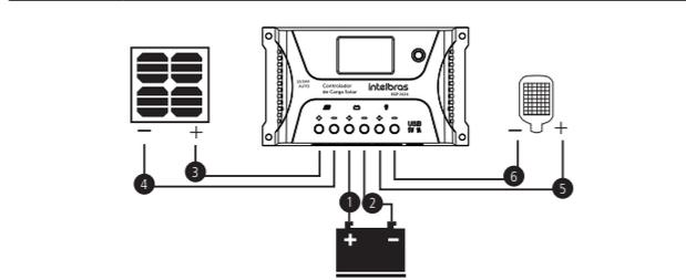
A conexão da(s) bateria(s), módulo ou arranjo de módulos e carga no controlador, deve ser feita de acordo com a sequência indicada na figura, sendo:
