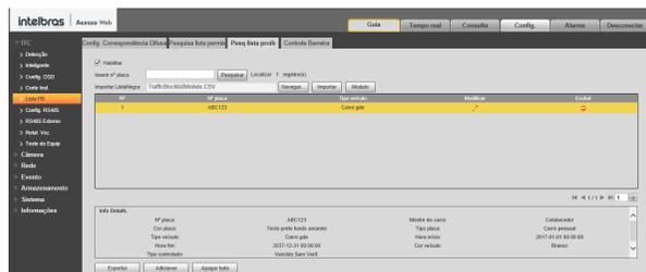
Na aba **Controle de Barreira**, é possível configurar os acionamentos que a câmera realizará, com base nos gatilhos iniciais (acionar saída de alarme dependendo do tipo de controle).
