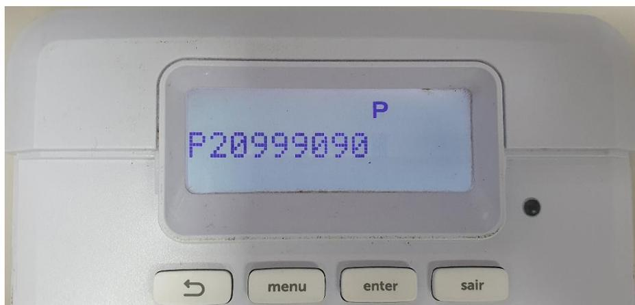
Após alterar a senha, para sair de programação basta digitar somente a **nova senha do instalador**, que no nosso exemplo é: **9090**
