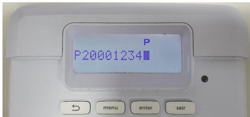
O teclado vai emitir bipes rápidos indicando a confirmação do comando de alteração da senha, mas se emitir um **bip longo**, a central não aceitou o comando, tente refazer verificando se o tempo não foi excedido.
