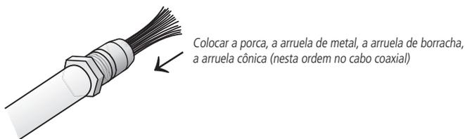
6. Introduzir o cabo com as arruelas na parte inferior do conector;
