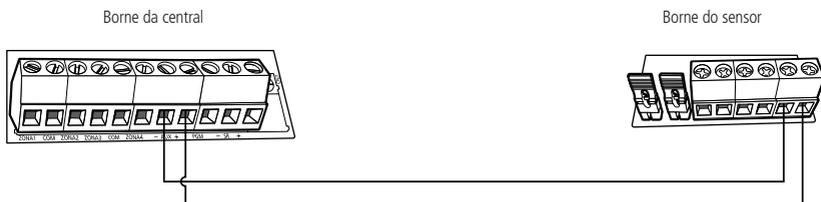
Esta saída é utilizada para alimentar acessórios, como por exemplo, sensores de infravermelho. Recomenda-se a utilização de um cabo com bitola ≤26 AWG (0,41 mm).
