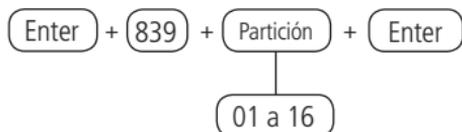
Utilice las teclas del teclado para configurar los días para que se autoactiven por partición, de modo que los números que deseen habilitar los días permanezcan marcados y los días con la función deshabilitada permanezcan sin marcar y luego ingresen con la tecla Enter.
