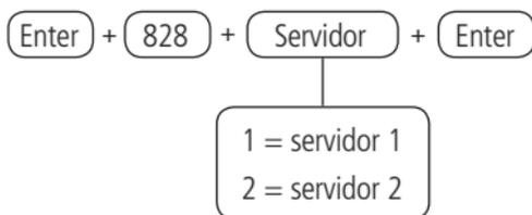
Después del comando, ingrese el código del servidor DNS (de acuerdo con el servidor utilizado) y presione la tecla Enter para confirmar.
