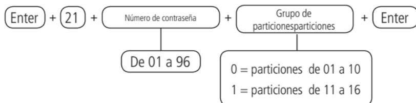
Después de ingresar el comando, usando el teclado XAT 8000, marque en qué particiones la contraseña tendrá permiso, usando los números de teclado para dejar marcado para la partición. Seleccione 0 para el grupo de particiones 1 a 10 y 1 para las particiones 11 a16. Después de alterar el valor configurado, presione la tecla Enter. Si solo desea ver la configuración, presione la tecla Atrás / Salir y ninguna programación será alterada.
