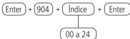
Después de ingresar el comando, ingrese el valor del evento en formato hexadecimal de 000 a FFF (acepta números del 0 al 9 y las letras B, C, D, E y F) y presione la tecla Enter para confirmar. Si solo desea ver la configuración, presione la tecla Salir y ninguna programación será alterada.
