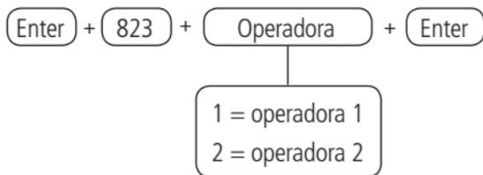
Después del comando, ingrese la contraseña (de acuerdo con la operadora contratada) y presione la tecla Enter para confirmar. Si solo desea ver la configuración, presione la tecla *Salir* para que no se cambie la programación.
