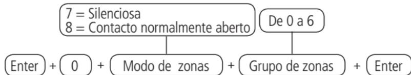
Utilice las teclas para configurar el modo de zona, de forma que los números de referencia, que deseen tener la zona con el modo determinado, permanezcan marcados y las zonas sin el modo permanezcan sin marcar y luego ingrese con la tecla Enter.
