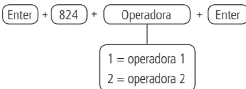
Después del comando, ingrese el APN (de acuerdo con la operadora contratada) y presione la tecla Enter para confirmar. Si solo desea ver la configuración, presione la tecla Salir y ninguna programación será alterada.
