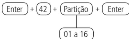
Después de alterar el valor establecido, presione la tecla Enter. Si solo desea visualizar la configuración, presione la tecla *Salir* y ninguna programación será alterada.
