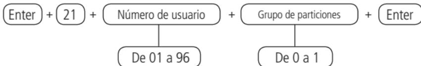
Después de ingresar el comando, usando el teclado XAT 8000, marque en qué particiones la contraseña tendrá permiso, usando los números de teclado para dejar marcado para la partición. Después de alterar el valor establecido, presione la tecla Enter. Si solo desea ver la configuración, presione la tecla Atrás / Salir y ninguna programación será alterada.
