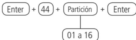
Después de alterar el valor configurado, presione la tecla Enter. Si solo desea visualizar la configuración, presione la tecla Salir y ninguna programación será alterada.
