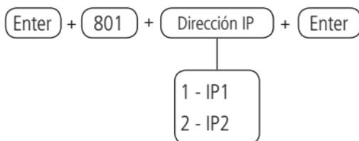
Después del comando, ingrese el número de IP de la empresa de monitoreo (ejemplo: 192.168.001.100) y presione la tecla Enter para confirmar. Si solo desea ver la configuración, presione la tecla Atrás/ Salir y ninguna programación será alterada.
