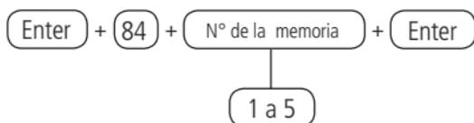
Después de alterar el valor establecido, presione la tecla Enter. Para eliminar el número registrado, presione la tecla Salir hasta que se borren todos los dígitos y luego presione la tecla Enter. Si solo desea ver la configuración, presione la tecla Atrás / Salir y ninguna programación será alterada.
