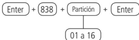
Utilice las teclas para configurar los días para que la partición se active automáticamente, de modo que los números correspondientes, que deseen tener los días habilitados, permanezcan marcados y los días con la función deshabilitada permanezcan sin marcar y luego confirmar con la tecla Enter.
