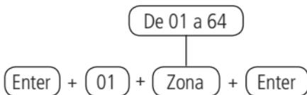
Después de alterar el valor establecido, presione la tecla Enter. Si solo desea ver la configuración, presione la tecla Atrás / Salir y ninguna programación será alterada.
