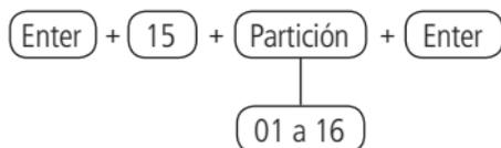
Después de ingresar el comando, siempre ingrese el código de cuenta de monitoreo con 4 dígitos y valores del 0 al 9 o las letras B, C, D, E y F. Si solo desea ver la configuración, presione la tecla Salir y ninguna programación será alterada.
