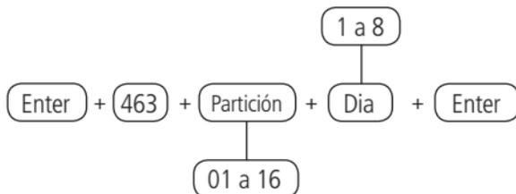
Después de alterar el valor establecido, presione la tecla Enter. Si solo desea ver la configuración, presione la tecla Atrás / Salir y ninguna programación será alterada.
