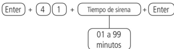
**Obs.:** si 00 está programado, sonará un sonido de error y la configuración no cambiará.
