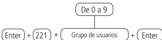
Use las teclas del teclado para permitir que los permisos permanezcan con los usuarios de las posiciones 01 a 96, de modo que los números correspondientes, que deseen habilitar la función, permanezcan marcados en la pantalla y luego confírmelos con la tecla Enter. Si solo desea ver la configuración, presione la tecla Atrás / Salir y ninguna programación será alterada.
