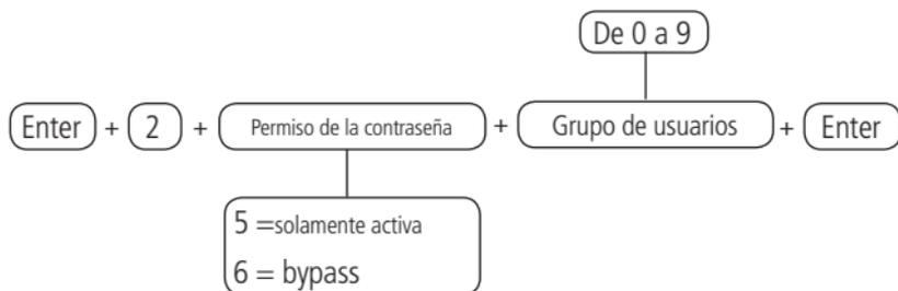
Use las teclas del teclado para habilitar los permisos para solamente activar y dar bypass solo a los usuarios de las posiciones 01 a 96, de modo que los números correspondientes que desee que tengan habilitada la función permanezcan marcados en la pantalla y luego confírmelos con la tecla Enter. Si solo desea ver la configuración, presione la tecla Atrás / Salir y ninguna programación será alterada.
