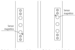
Fechadura no lado esquerdo da porta: Fechadura no lado direito da porta: sensor magnético para baixo sensor magnético para cima
