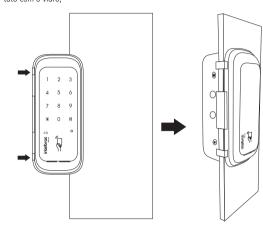
3. Feche a porta e gire a manopla para projetar a lingueta da fechadura. Pegue o batente e verifique a altura necessária para que haja o alinhamento do batente com a fechadura. Note que o batente possui 2 lados distintos — 1 de cor preta e 1 de cor prata. O batente deve ser posicionado de forma a combinar com a fechadura (preto com preto, prata
