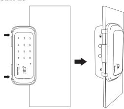
Feche a porta e gire a manopla para projetar a lingueta da fechadura. Utilize a falsa-testa como gabarito e verifique a posição correta para o alinhamento entre fechadura e a falsatesta. Utilize um lápis/caneta e marque furos da falsa-testa na forra. Utilize uma broca de 14 mm para abrir os 3 furos centrais;
