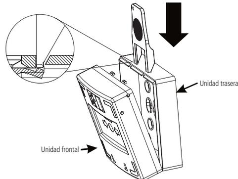
2. Atornille la unidad posterior a la pared y conecte los cables de acuerdo con el diagrama de cableado;
