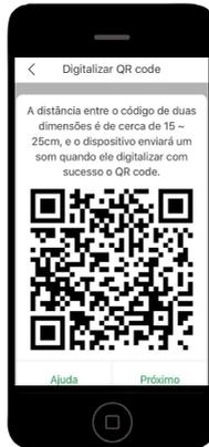
**Obs.:** asegúrese de que no haya reflejos en la pantalla causados por la iluminación ambiental. Si el videoportero no lee el código QR, cambie la posición del teléfono móvil y del videoportero, asegurándose de que no se produzcan reflejos en la pantalla del móvil.
