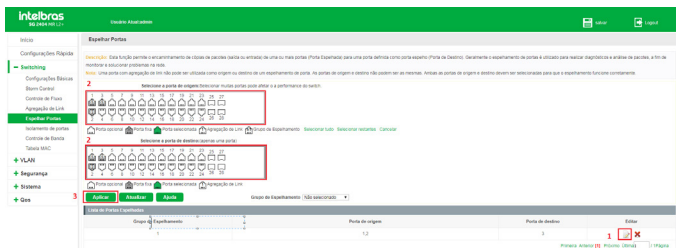
Switching - Modificando espelhamento de porta
