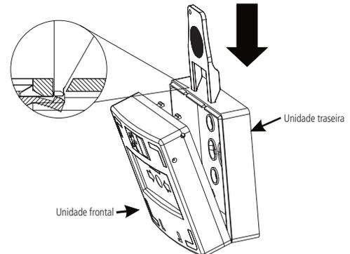
2. Parafuse a unidade traseira na parede e conecte os cabos conforme esquema de ligação;
