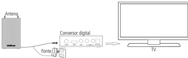
1. Conecte o conector *F* da antena no conversor digital na posição *Entrada de antena*;
