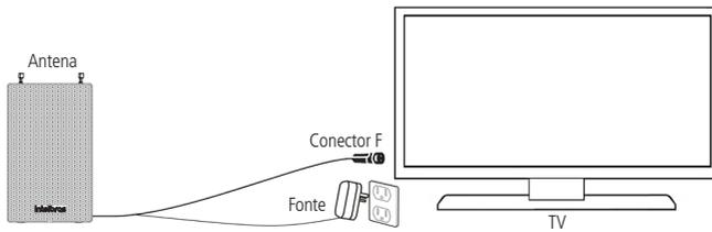
1. Conecte o conector *F* da antena na TV, na posição *Entrada antena*;
