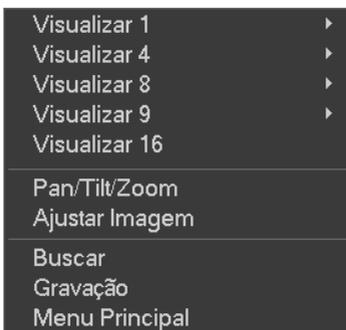
Em seguida, vá até *Pan/Tilt/Zoom*, ou pressione o botão *Fn* no controle remoto. A interface será exibida conforme a figura *PTZ* no item *Operações de PTZ*.
