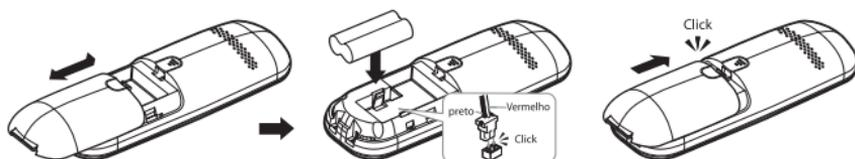
*Instalación de la batería*
