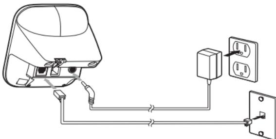
Conexión de las líneas telefónicas y del adaptador de tensión
