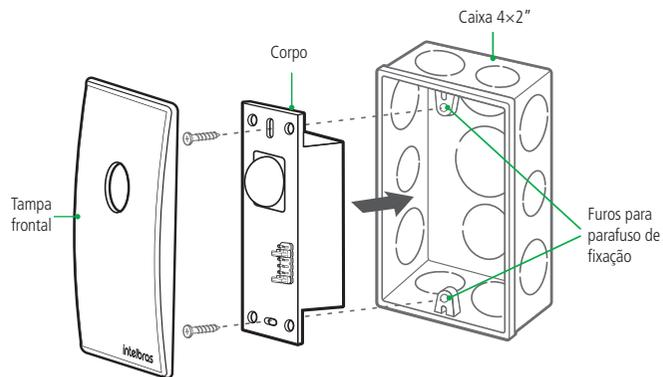
Fixação e instalação do sensor ESP 180 E
