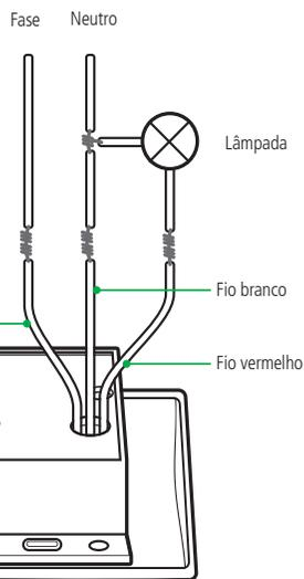
2. Destaque a tampa frontal do sensor ESP 180 E de modo que seja possível fixar o corpo do sensor na caixa 4x2" (caixa de tomada), de acordo com a ilustração a seguir:
